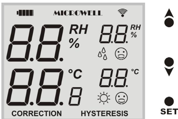
**Angezeigte Daten im Display des Senders (Messgerät)**
