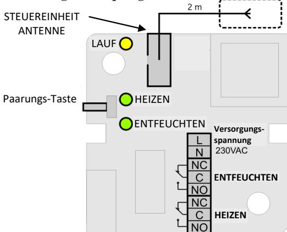
**Abbildung des Senders (Messgerät)**
