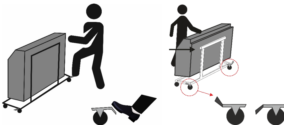
Obr.1 Po presunutí odvlhčovača na mobilnom stojane na miesto inštalácie, zaistite brzdou kolies. Brzda kolies je zaistená, keď je páčka brzdy dole. Brzda kolies je odistená, keď páčka je hore.
