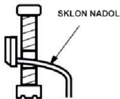
Korrekte Installation des Kondensationsschlauchs
