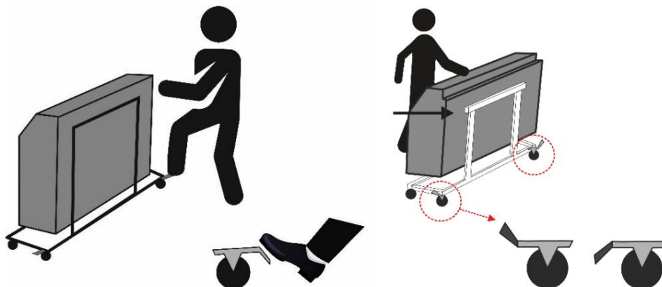
Abb. 1: Nachdem Athmoss auf dem mobilen Stativ zum Einsatzort bewegt wurde, muss die Radbremse (Feststellbremse) gesichert werden. Die Radbremse ist arretiert, wenn der Bremshebel unten ist. Sie ist gelöst, wenn der Hebel oben ist.
