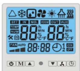
Obrázok: Displej ukazujú všetky jeho indikátory v momente kedy je tepelné čerpadlo napojené na zdroj napätia.
