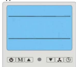
Obrázok: Prázdny displej naznačuje žiadne pripojenie ku zdroju a celkové vypnutie tepelného čerpadla.
