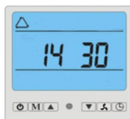
Picture: Ábra: Paraméterek ellenőrzése, a beáramló víz hőmérséklete 30°C.
