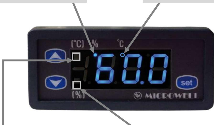
Zasvietený štvorček signalizuje, že **regulátor dáva signál na ohrev vzduchu** (v prípade, ak sú nainštalované teplovodná vložka a solenoidový ventil.) Nevysvietený symbol signalizuje, že požadovaná teplota vzduchu je nižšia ako skutočná.
