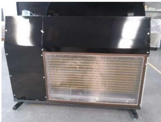
**1.** Odstráňte kryt odvlhčovača. Zvýšenú pozornosť venujte konektorom regulátora, ako sú káble a antény.
