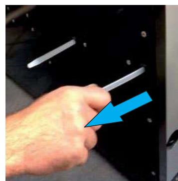
*Obr. 3:* Nakoniec vytiahnite pásku so zariadenia a odstraňte ju.
