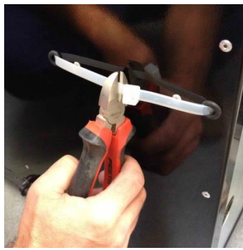
Picture 2: Durchtrennen mit einer Zange
