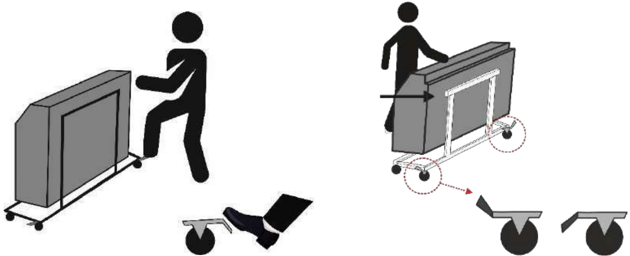
Abb.1 Nachdem Sie den Luftentfeuchter auf dem mobilen Ständer zum Aufstellungsort gebracht haben, sichern Sie die Radbremse. Die Radbremse ist gesichert, wenn der Bremshebel unten ist. Die Radbremse ist gelöst, wenn der Hebel oben ist.
