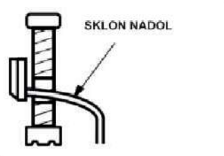
Korrekte Installation des Kondensationsschlauchs
