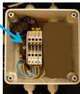
Obrázok: Štvor-pinové pripojenie vodnej jednotky (1-4 pripojenie senzorov so vzduchovou jednotkou).
