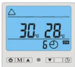
Obrázok: Časovač je nastavený. Tepelné čerpadlo sa zapne o 6 hodín.
