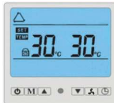
Obrázok: Detská poistka je aktivovaná. Ikona zámky sa ukáže na ľavej strane.
