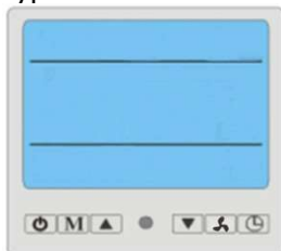
Obrázok: Prázdny displej naznačuje žiadne pripojenie ku zdroju a celkové vypnutie tepelného čerpadla.
