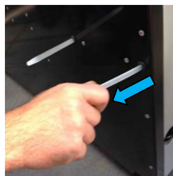
Obr. 3: Nakoniec vytiahnite pásku z odvlhčovača.
