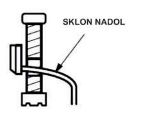
Správna inštalácia kondenzačnej hadice
