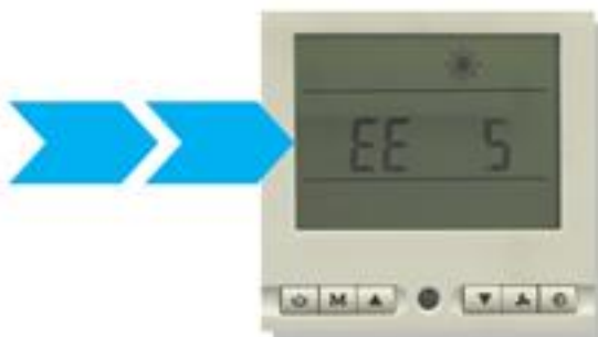
Chybový kód "EE5" upozorňující na nízký / vysoký průtok vody nebo zkažený průtokový spínač.
