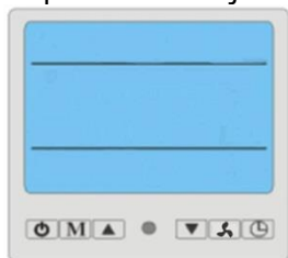
Obrázek: Prázdný displej naznačuje žádné připojení ke zdroji a celkové vypnutí tepelného čerpadla.
