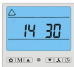
Obrázek: Kontrola parametrů, vstupní teplota vody je 30 ° C.
