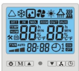
Obrázek: Displej ukazující všechny jeho indikátory v momentě kdy je tepelné čerpadlo napojené na zdroj napětí.
