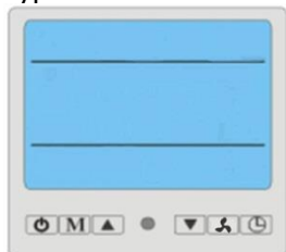
Obrázek: Prázdný displej naznačuje žádné připojení ke zdroji a celkové vypnutí tepelného čerpadla.
