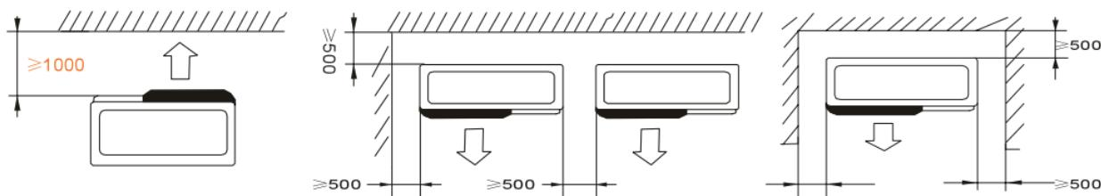
Ve vzdálenosti nejméně 2 m před tepelným čerpadlem nesmí být nic umístěno.
